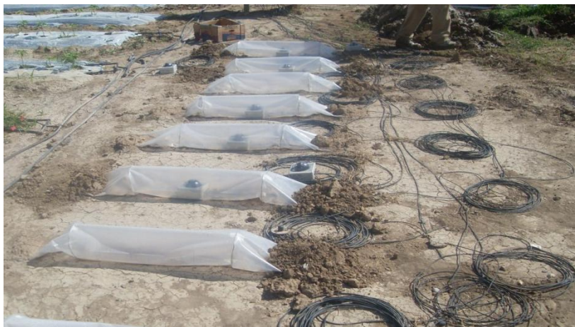
Figura 3.1 Evaluación de las propiedades ópticas de las diferentes películas en campo.
